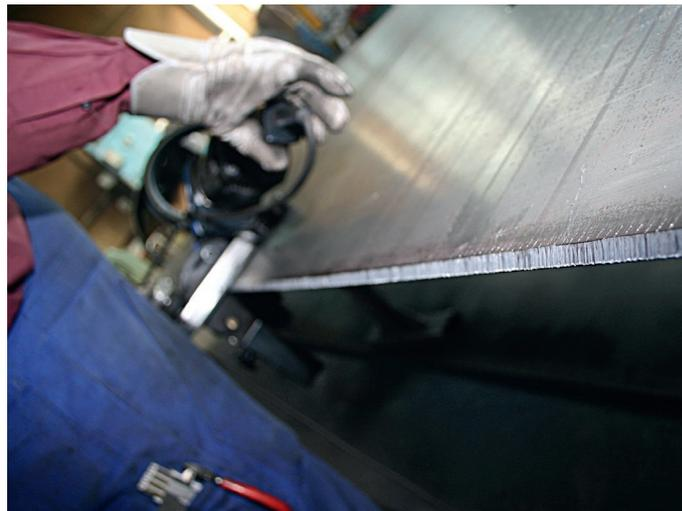
▲ Kantenformer eignen sich vor allem für die wirtschaftliche Erzeugung von Schweißkanten. Die Kantenoberflächen sind oxidfrei und metallisch blank
