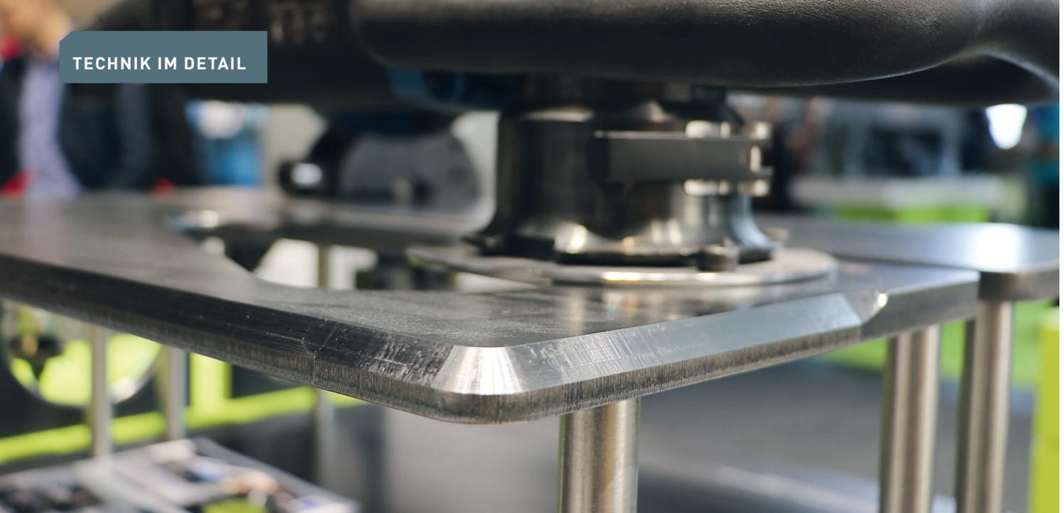
▲ Das Ergebnis des Kantenfräasers: Eine metallisch blanke Kante mit hochwertigem Glanz
