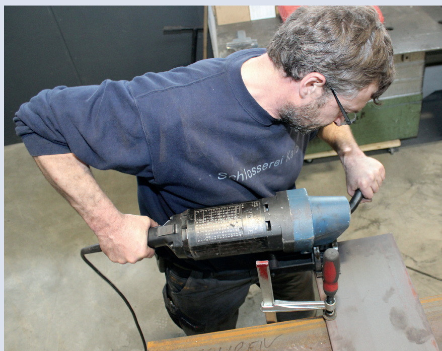
Schweißfachmann Andreas Mostögl schätzt, dass sich der TKF dank des ergonomischen Aufbaus trotz des Gewichtes von 16,5 Kilogramm relativ gut handhaben lässt.
