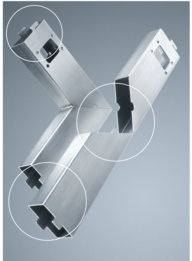
Effiziente Herstellung von Knickverbindungen und Positionierhilfen mit dem Laser.
