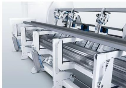
Einschwenkbare Förderstrecke an der TruLaser Tube 7000 für kleine Losgrößen und Sonderprofile.
