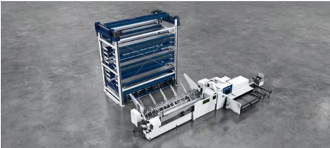
Rohrlager mit Lageranbindung. Dank der neuen Beladeautomatisierung zwischen Rohrlager und TruLaser Tube 7000 fiber beladen Sie Ihre Maschine nun vollautomatisch und unbeaufsichtigt.
