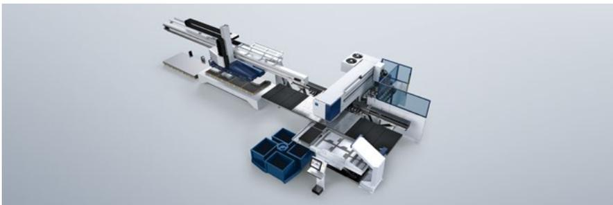
TruPunch 5000 mit SheetMaster, SortMaster Box, GripMaster und ToolMaster Linear.
