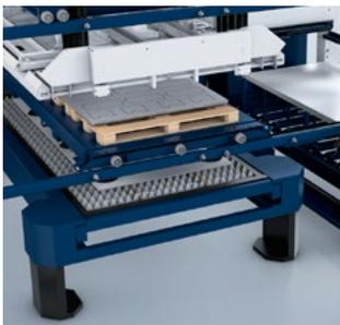
Als Herzstück des LiftMaster Compact sorgt der Synchronloader für paralleles Be- und Entladen.
