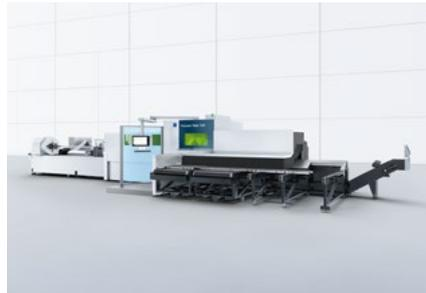
Voll automatisiertes Materialhandling an der TruLaser Tube 7000: beladen, entladen, sortieren, Reste entsorgen.
