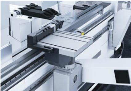
Zangengreifer mit Verschiebe- und Drehachse bearbeiten Kleinteile hochproduktiv.
