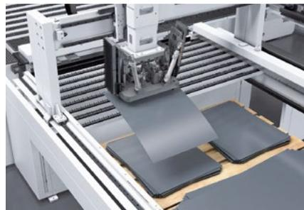
Der Sauggreifer belädt die TruBend Center 7030 automatisch mit großen oder kleinen Platinen, während die Maschine arbeitet.
