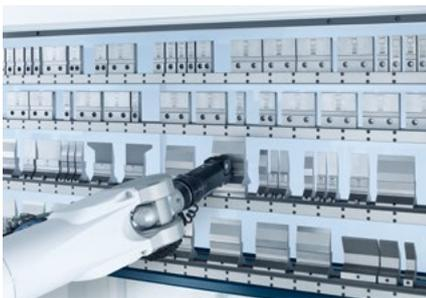
Der ToolMaster Bend rüstet Werkzeuge vollautomatisch.
