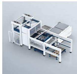
LiftMaster Compact in Linear-Ausführung ermöglicht die Restgittertrennung für automatische Teilvereinzlung.
