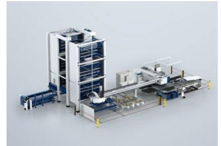
TruMatic 7000 an TruStore 3030 mit SheetMaster, Doppelwagen auf Schienen, SortMaster Pallet, SortMaster Box und GripMaster.
