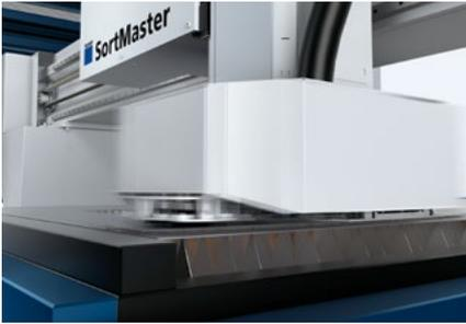
Smart Functions: Überwachung der Teiletrennung und effektivere Trennung der Gutteile vom Restgitter dank Vibration am Greiferkopf.
