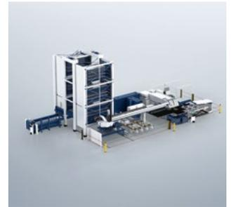
TruMatic 7000 mit SheetMaster und Doppelwagen, indirekt an TruStore 3030 angebunden.
