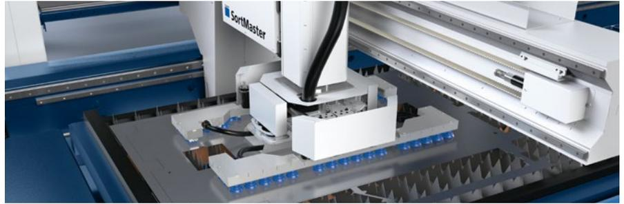
Zusätzlicher Greifer entnimmt Teile bis 1000 x 1500 mm und lässt sich einfach via Greiferkupplung anbinden.
