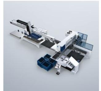
TruPunch 5000 mit SheetMaster, SortMaster Box, GripMaster und ToolMaster Linear.
