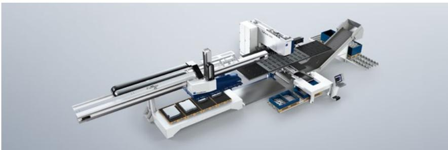
TruPunch 3000 mit SheetMaster mit integriertem Werkzeugwechsler, SortMaster Box Linear und DisposeMaster.
