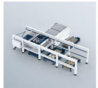
Die Erweiterung um zusätzliche Portalstationen führt zu größerer Flexibilität im Materialfluss.
