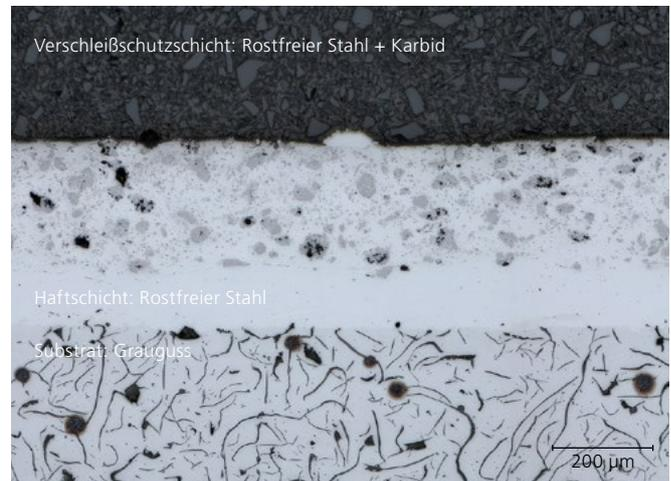
Verschleißschutzschicht: Rostfreier Stahl + Karbid
