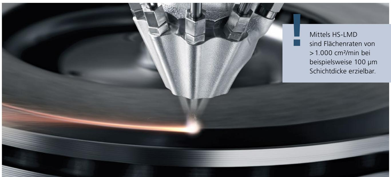
Mittels HS-LMD sind Flächenraten von  $> 1.000$  cm<sup>2</sup>/min bei beispielsweise 100  $\mu$ m Schichtdicke erzielbar.
