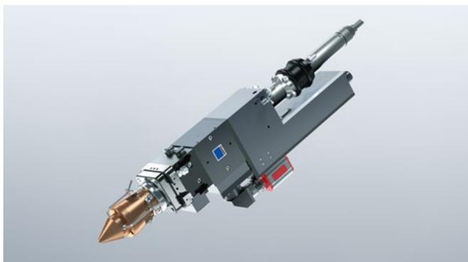
Die bewährte Optik BEO D 70 verfügt über eine programmierbare motorische Fokussierung und eine Digitalkamera für noch höhere Prozesssicherheit. Die speziell für das Verfahren entwickelten Pulverdüsen sorgen für eine optimale Verteilung des Pulverstroms.
