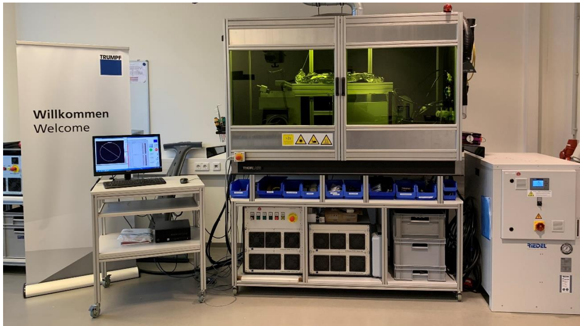
사진 2: Aachen 연결 기술 센터의 장치 냉각 유닛, 드라이버 유닛 및 제어 PC가 있는 레이저실
