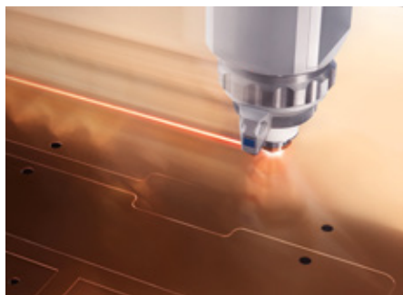
24 千瓦的 TruDisk 24001 激光器能够以极高的生产力和出色的质量加工各种材料。
