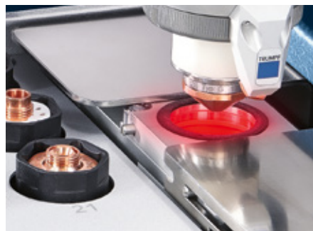
智能喷嘴自动化能确保让喷嘴和透镜保持健康状态。
