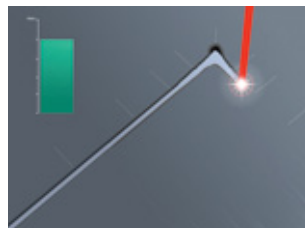
不同步调整激光参数会带来不整洁的边缘
