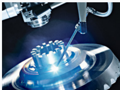
所输送的保护气体优化了焊接效果，减少了焊缝的返工几率。
