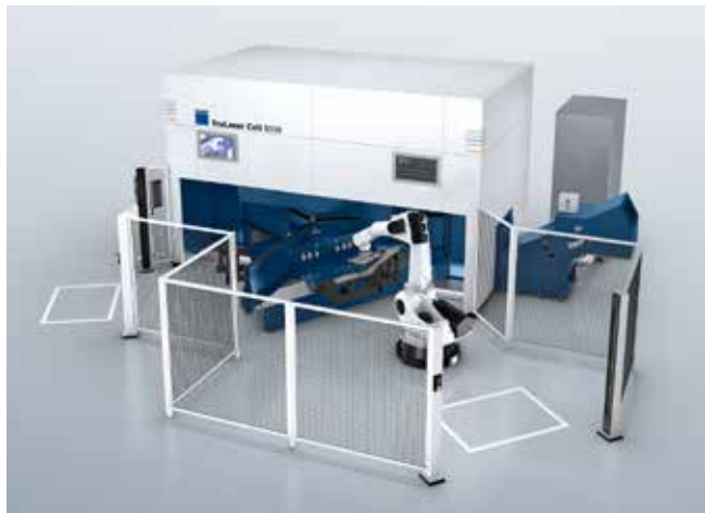
旋转分度台和机器人将周期时间降至最低。
