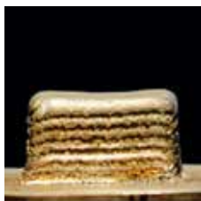
增材制造的十层工件块。工件和喷嘴方向的变化会导致垂直面产生巨大的变化。
