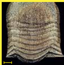
堆叠焊道的宏观图：M 形层边界非常明显。内部结构对堆叠的外部表面也有影响。
