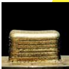
增材制造的十层工件块。工件和喷嘴方向的变化会导致垂直面产生巨大的变化。
