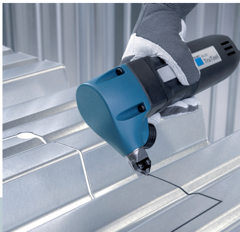
Ausklünnungen und Innenausschnitte
