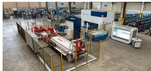
Das Zusammenspiel einer automatisierten TruLaser Tube 7000 fiber und einer TruLaser Cell 8030 von TRUMPF, sowie einer Rohrbiegemaschine von TRUMPF Partner transfluid® meistert auch komplexe Aufgaben der
